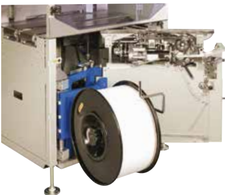
Bandspule mit Schnellwechselsystem - Einfacher Rollenwechsel in ergonomischer Position
