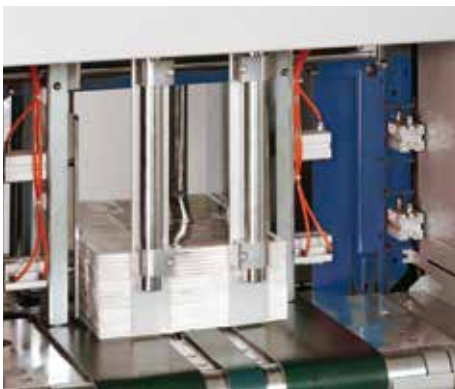
Automatische, 6-Seiten Packstück Ausrichtung
